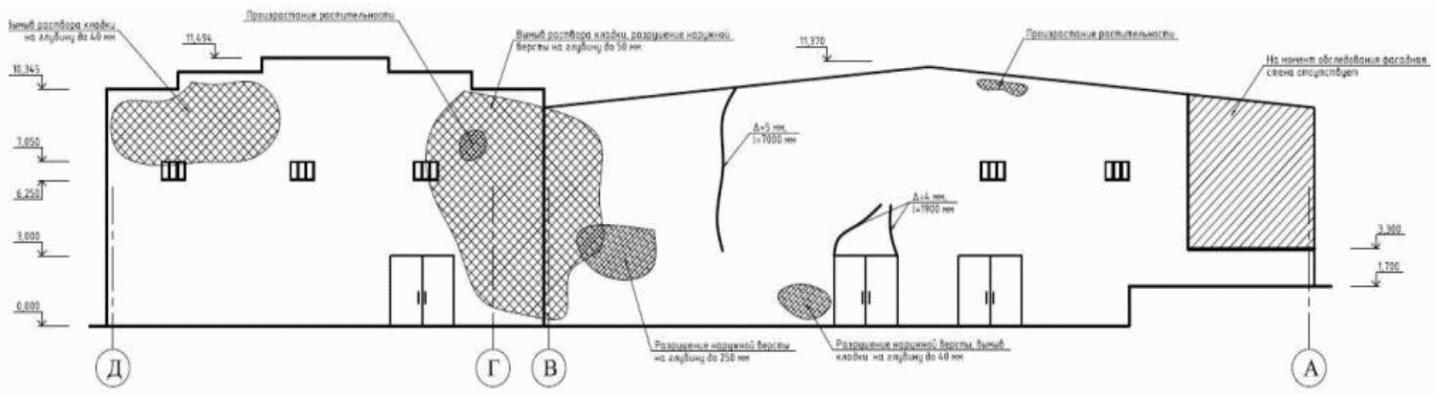
Рисунок 2.1. Пример схемы расположения дефектов на фасаде здания
