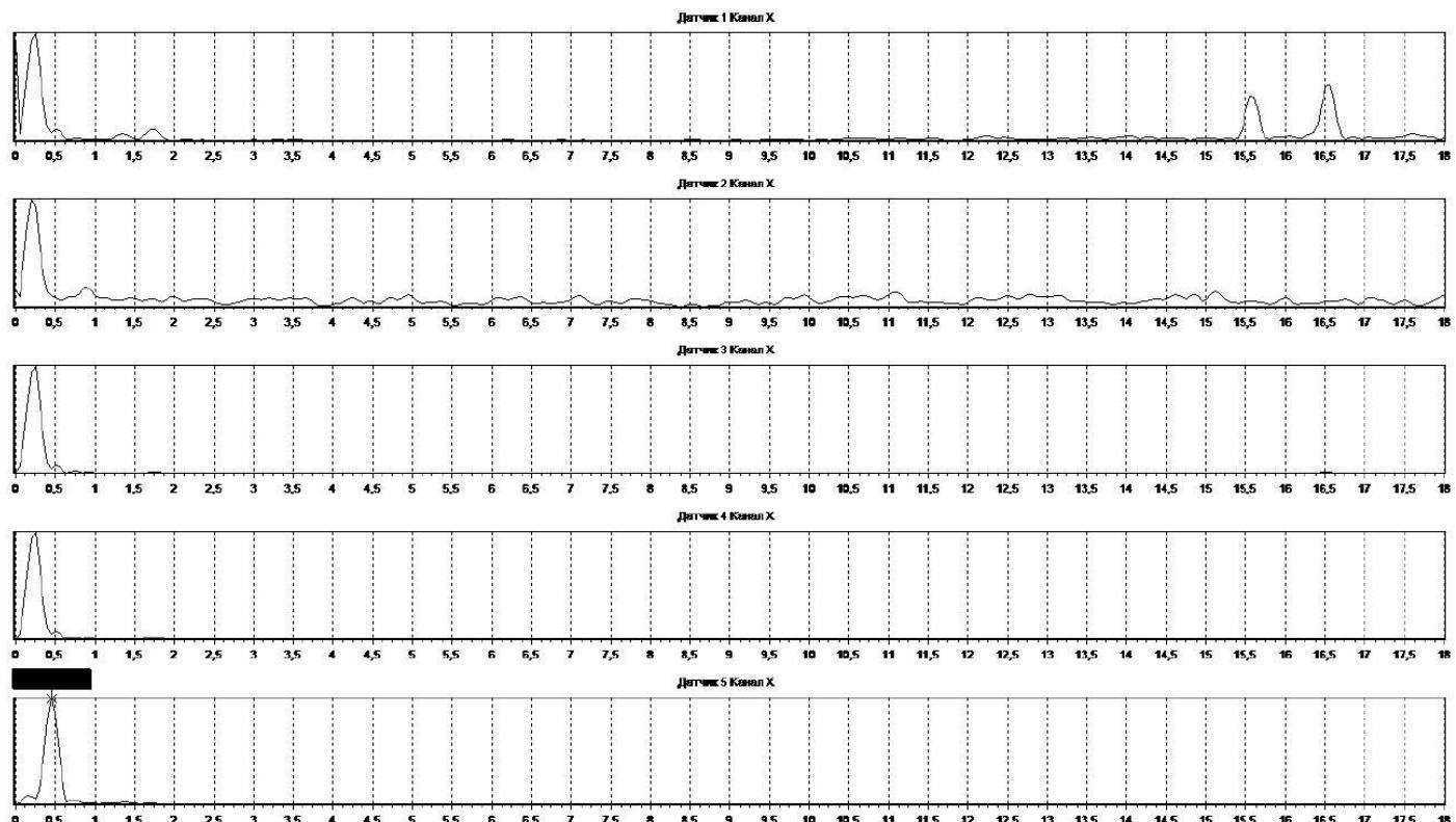
Рис. 2.3 Пример спектра колебаний башни по оси X
