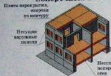
с большим шагом несущих поперечных стен
