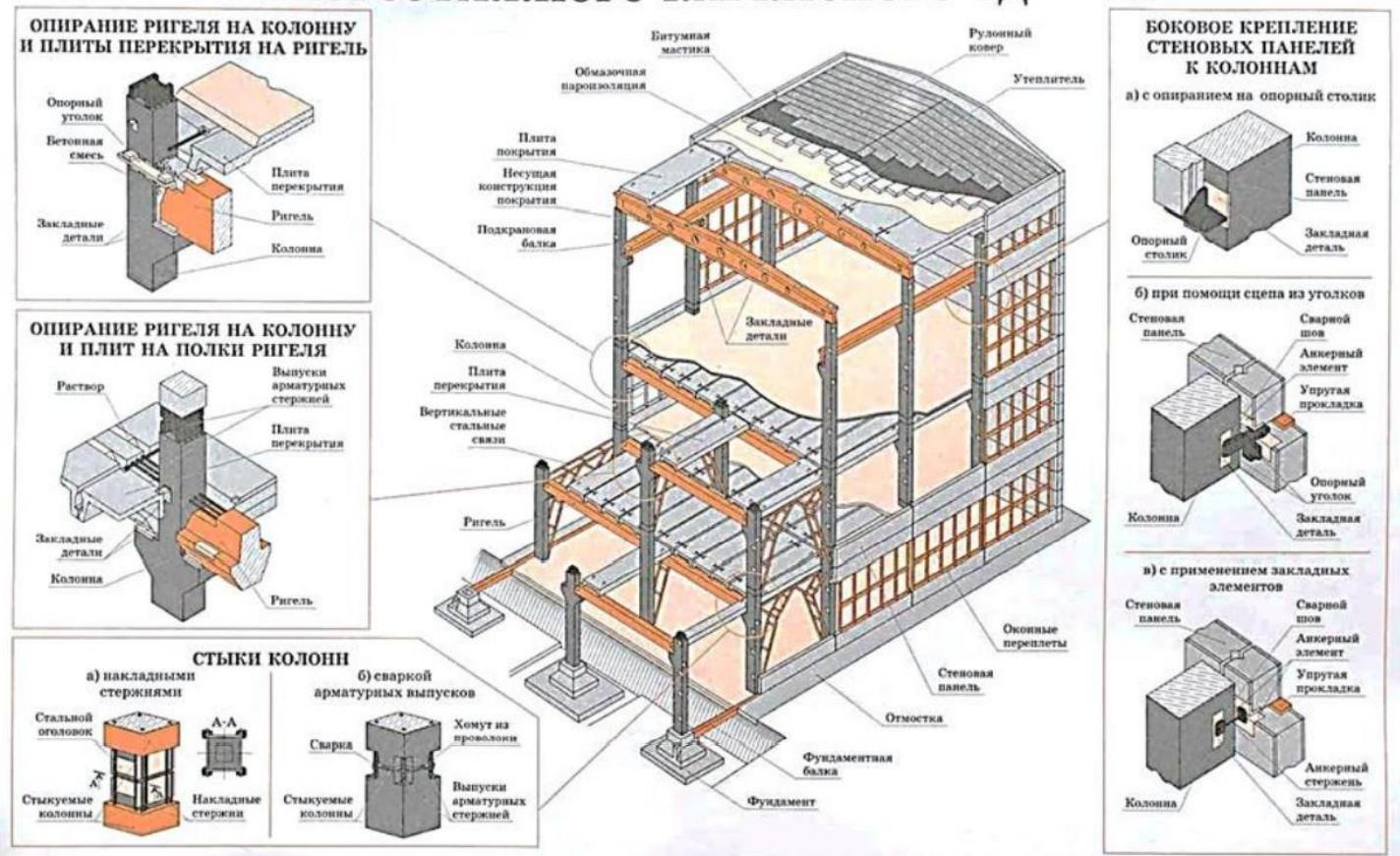
Рисунок 2.5. Основные конструктивные элементы многоэтажного промышленного здания
