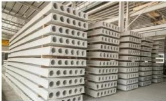
Рисунок 1 - Пустотные железобетонные плиты
