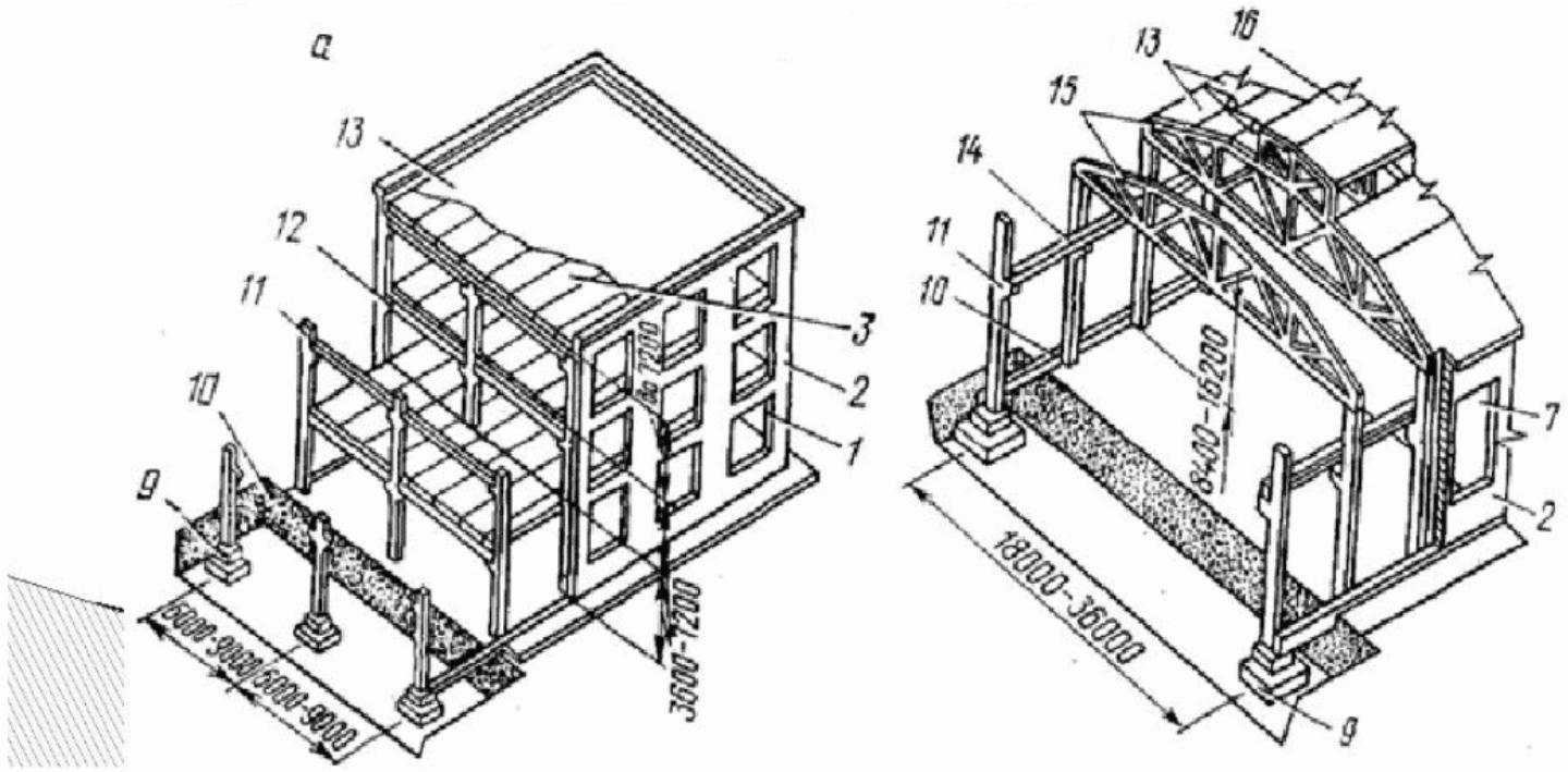
Рисунок 2.3. Конструктивные схемы промышленных зданий
