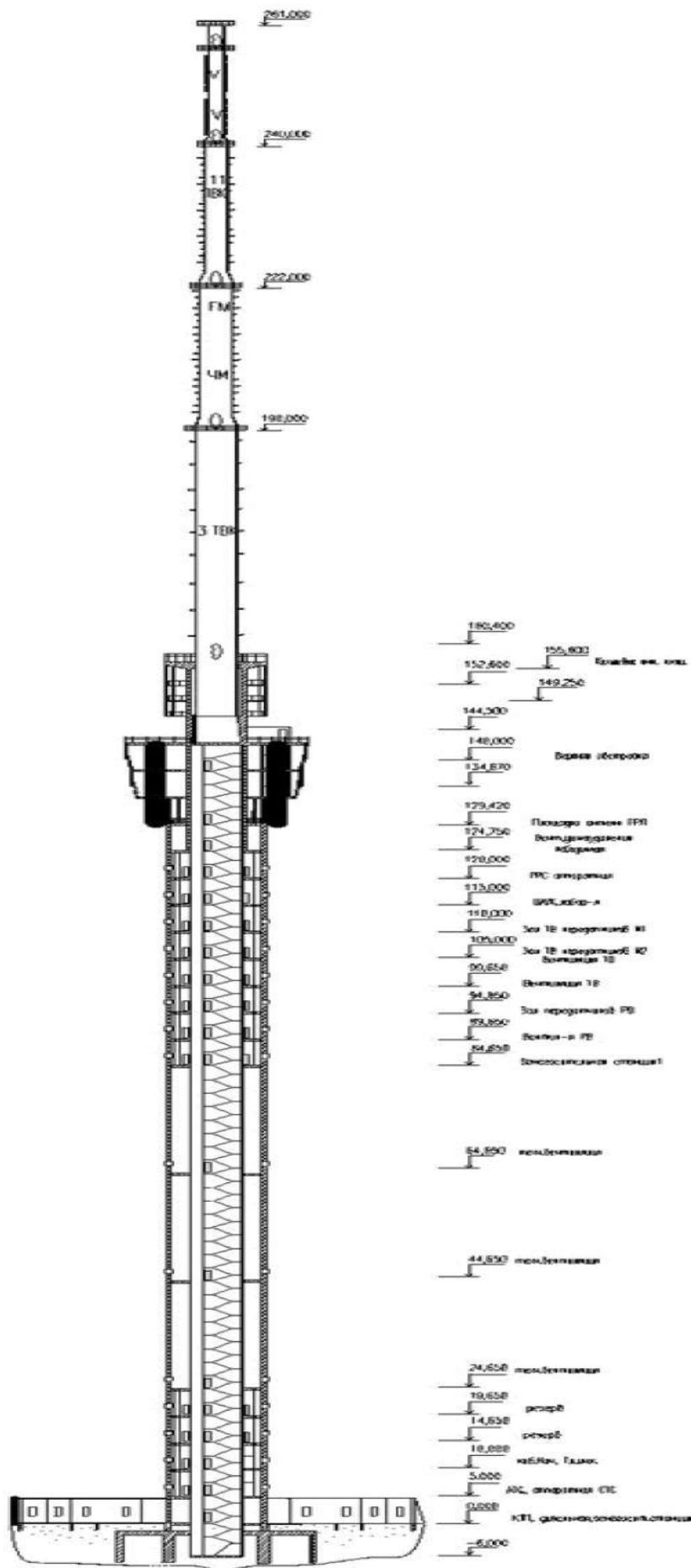
Рис. 2.1. Пример расстановки датчиков по высоте сооружения: нижней точкой расстановки был машинный зал лифтов в подвале сооружения, верхней точкой расстановки был уровень +190,0 м
