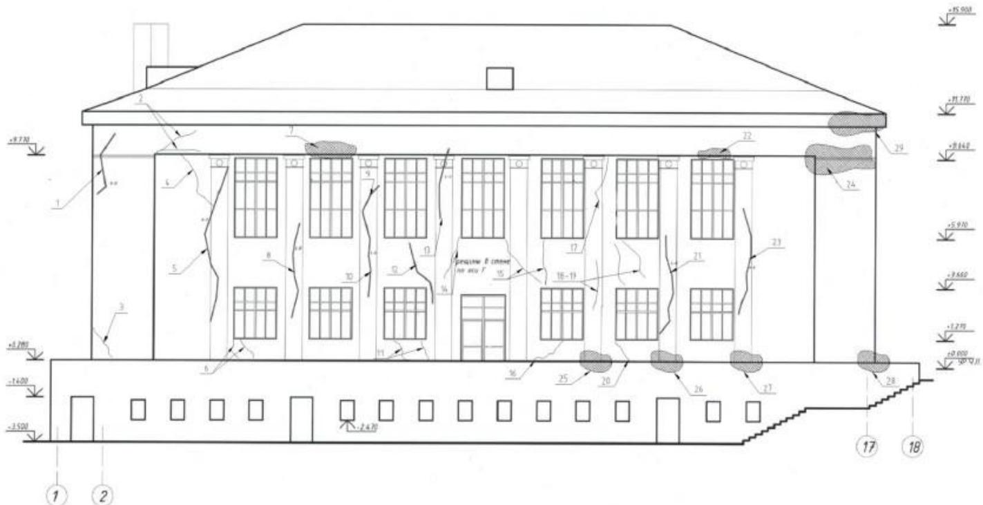
Рис. 2.1. Пример схемы расположения дефектов на фасаде здания в осях А-Г/1-18
