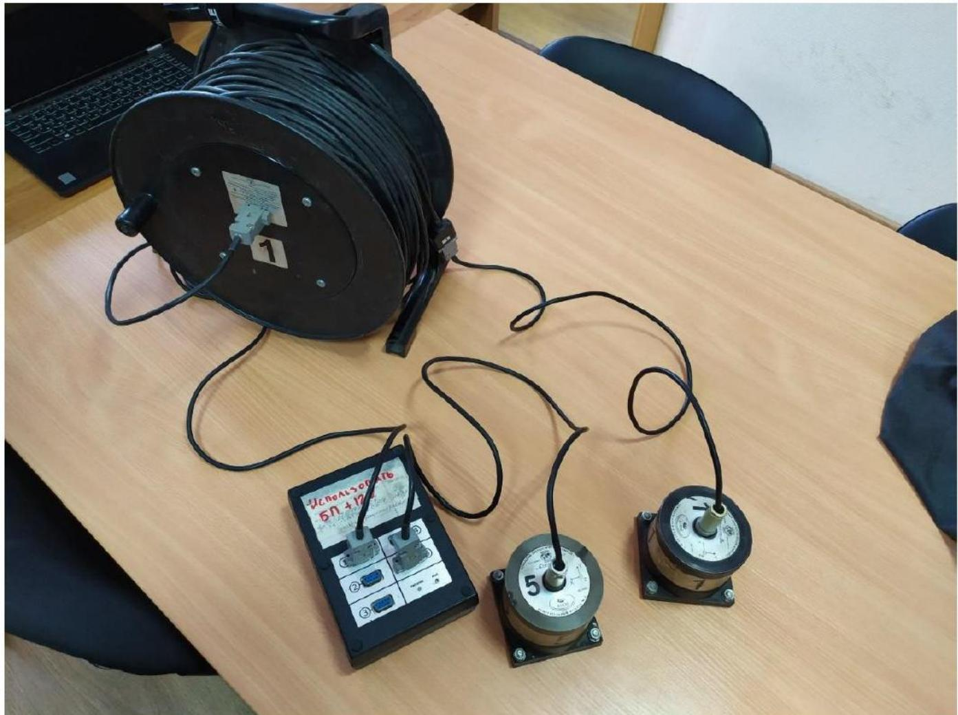
Фото 2.4. Пример соединения датчиков через катушку
