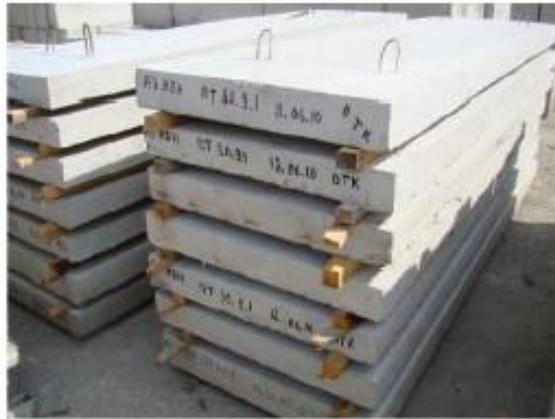
Рисунок 3 - Сплошные железобетонные плиты
