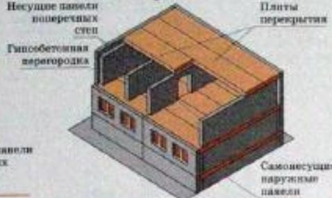
со смешанным шагом несущих поперечных стен
