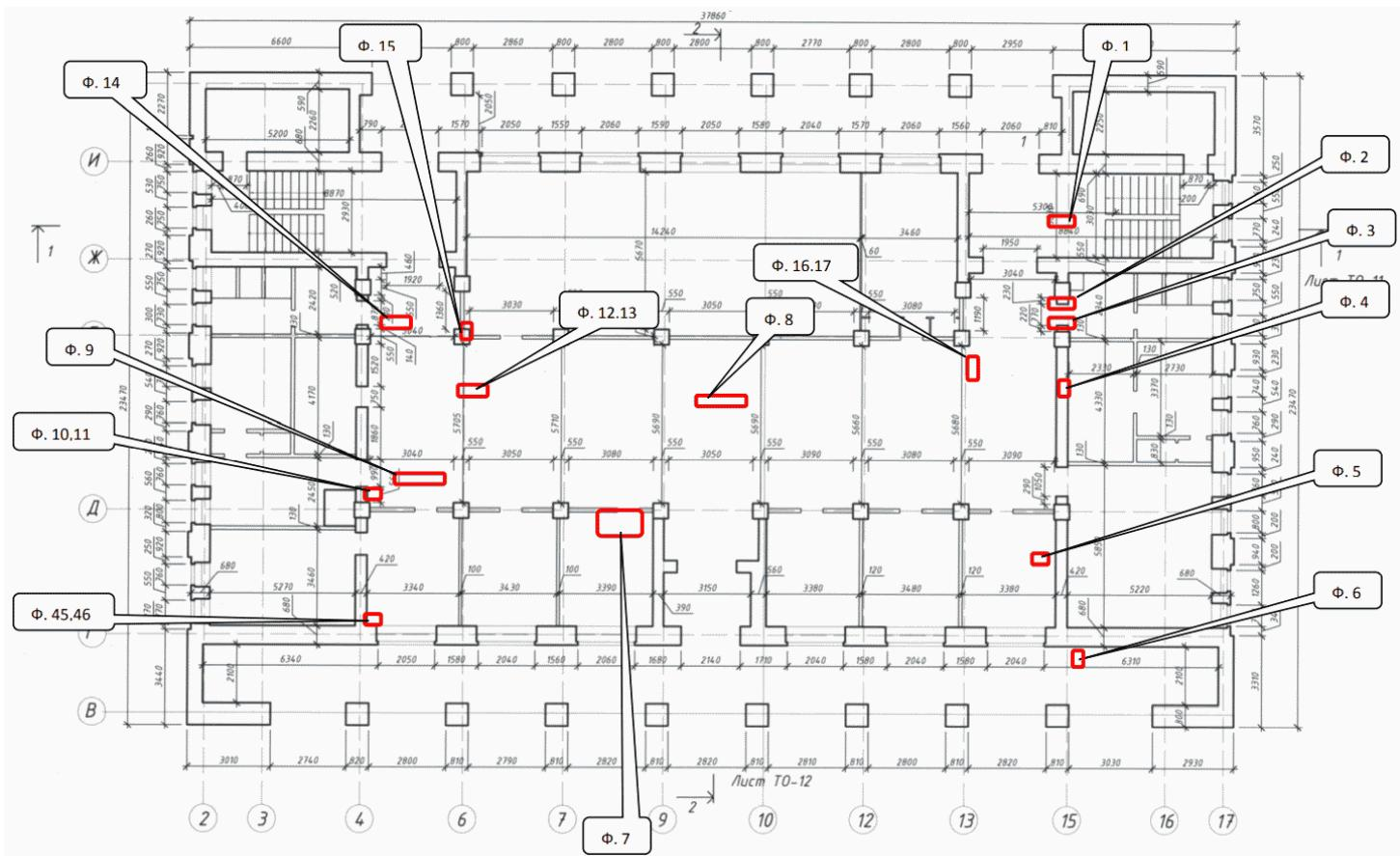
Рисунок 2.2. Пример схемы расположения дефектов в плане
